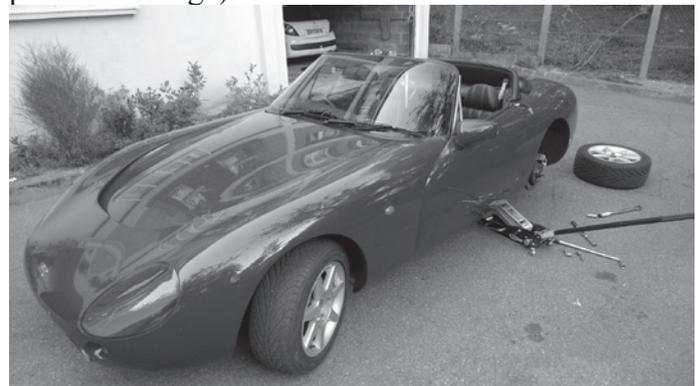
Les coins des longerons («outriggers») peuvent servir de points de levage. Alternativement, les poutres centrales du châssis sont également de bons points d'appui.
