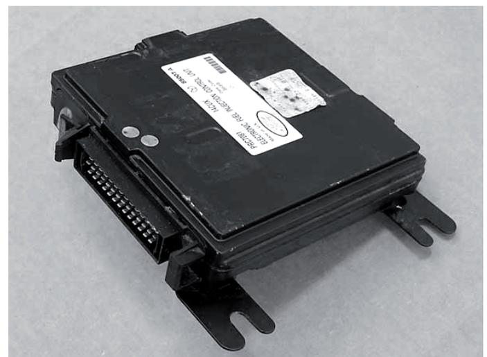
Divers capteurs montés sur le moteur pour mesurer les paramètres de fonctionnement de celui-ci sont connectés au calculateur.
