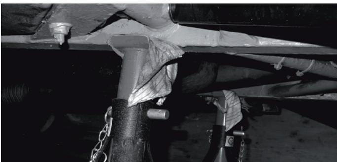
*Positionnement des chandelles sur les longerons centraux sous le châssis à l'avant*
