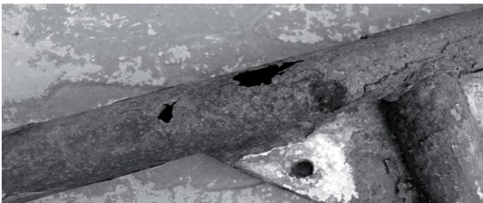
*Outriggers avec corrosion perforante : À changer absolument.*
