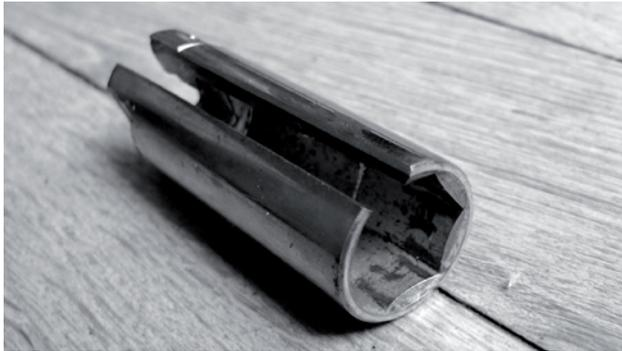
*Douille sur mesure pour le démontage des sondes lambda*
